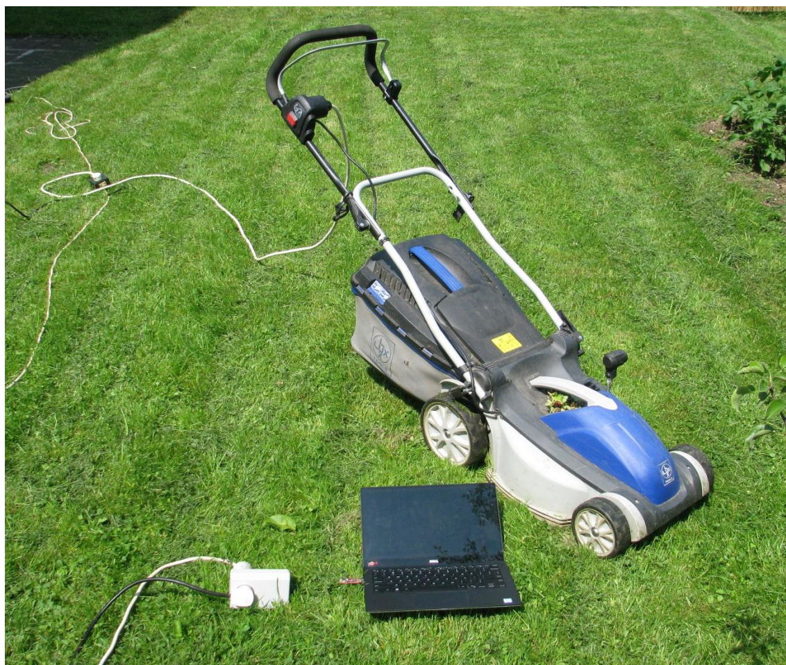
Obrázek 18: Sestava pro měření výkonu odebíraného sekačkou při kontrolním měření
